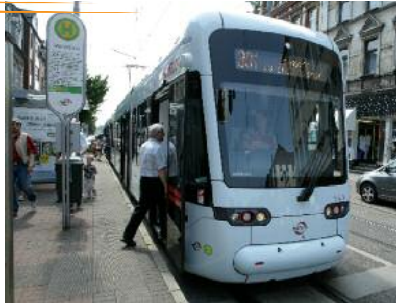
Einfach besser: Der niveaugleiche Ausbau der Haltestellen erleichtert zukünftig allen Fahrgästen den Zugang zur Straßenbahn.
